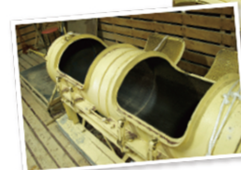
乾いた天草をこの機械に押し込み俵型に押し固める。
